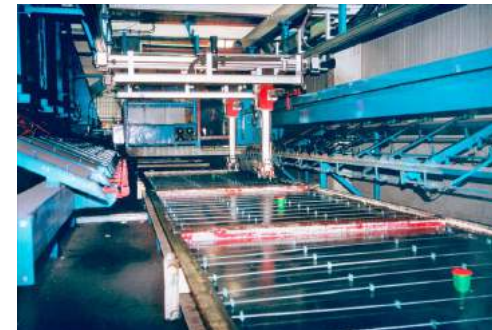
Linearroboter bei Bewehrungsverlegung
